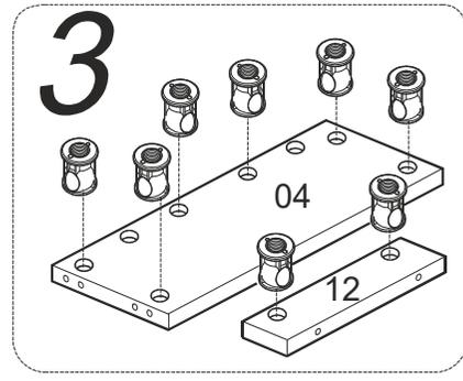
Верхний щит тумбы имеет два недосверленных отверстия н 8мм, гл.23мм для стяжек см-2. Необходимо проколоть шилом щиты насквозь в центре отверстия и с обратной стороны увеличить образовавшийся просвет до 8мм
