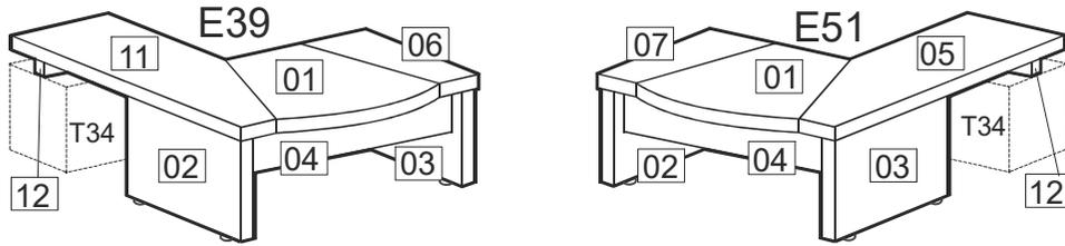
Показана сборка стола E51. Сборка стола E39 аналогична.
